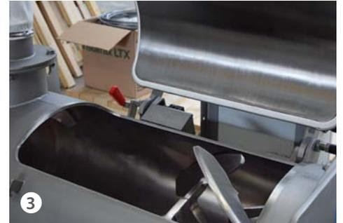
3 Boccaporto di carico e di ispezione con sicurezza
