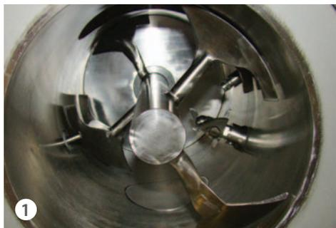
1 Interno camera con vomeri saldati e trattamento di lucidatura
