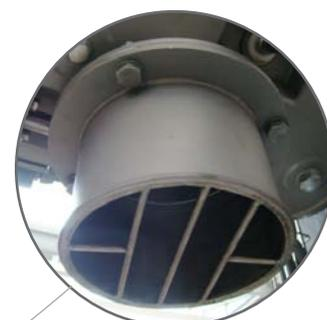
Bocca di scarico con apertura manuale e griglia di sicurezza
