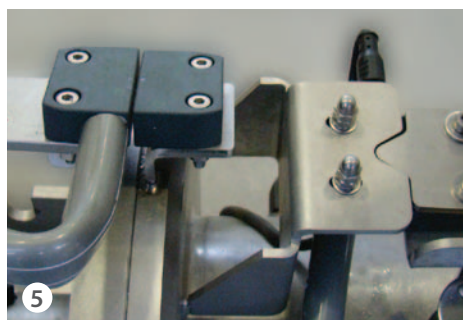
5 Sensor de seguridad magnético
