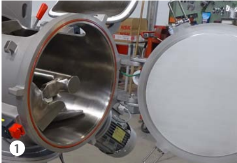
1 Puerta lateral con sistema de seguridad
