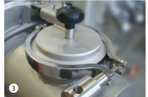
3 Boca de cierre reconstructiva
