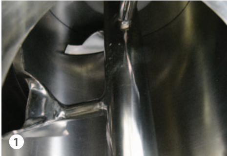
1 Interior de la cámara con aspas de arados soldados y tratamiento pulido
