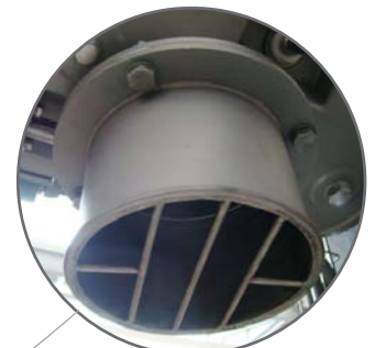
Boca de descarga con apertura manual y rejilla de seguridad
