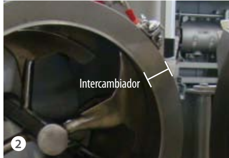
2 Cámara de mezclado completa con intercambiador de calor en la parte cilíndrica (opcional)
