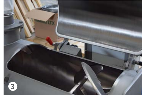
3 Puerta de carga y inspección con sistema de seguridad
