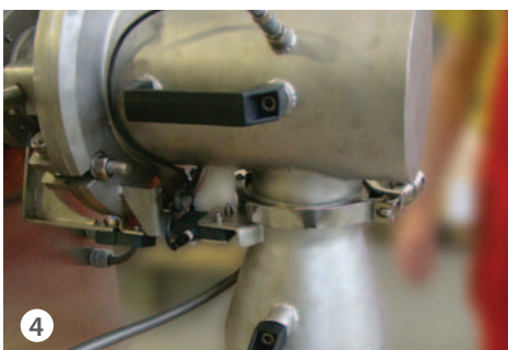
4 Rotación de la cuba para la descarga del producto
