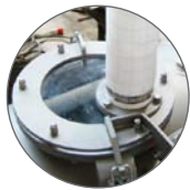
Tapa de cierre con ventanilla visuales y manguito de filtración
