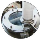
Verschlussdeckel mit Schauglas und Filterschlauch
