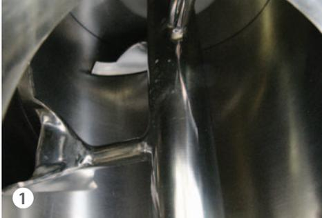
1 Mischkammerinnenseite mit verschweißten Pflugscharen und polierter Oberfläche
