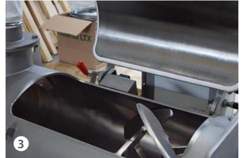
3 Befüll- und Inspektionsluke mit Sicherheitsenschalter
