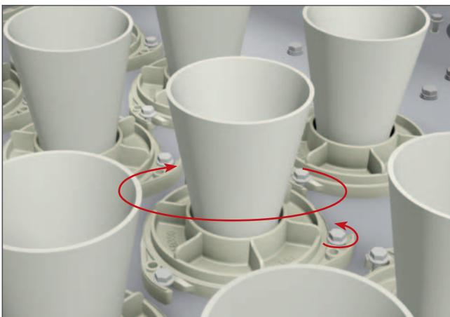
Alojar los tornillos de bloqueo y girar el elemento filtrante hasta que se suelte
