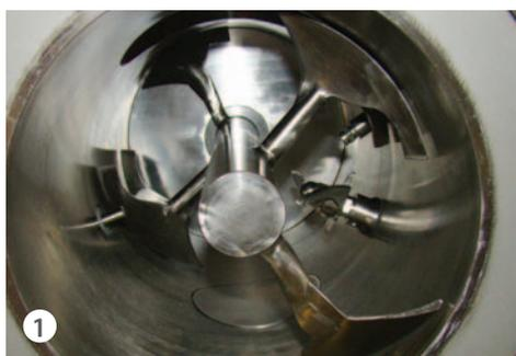
1 Interno camera con vomeri saldati e trattamento di lucidatura
