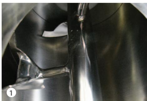
Interno camera con vomeri saldati e trattamento di lucidatura
