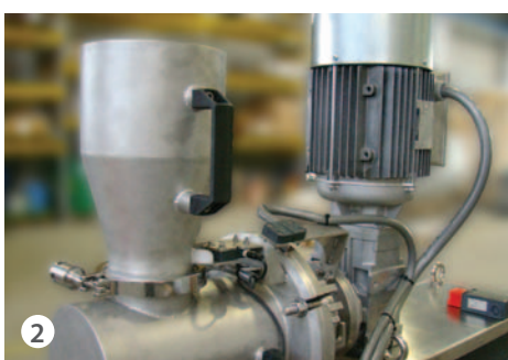
2 Récipient de chargement/déchargement produit
