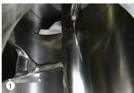
1 Intérieur de la chambre avec socs soudés et traitement de polissage
