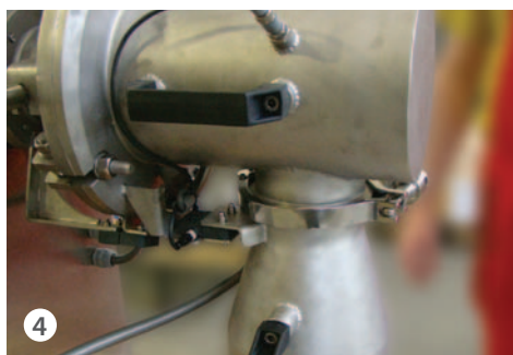
4 Rotation de la chambre, pour dechargement produit
