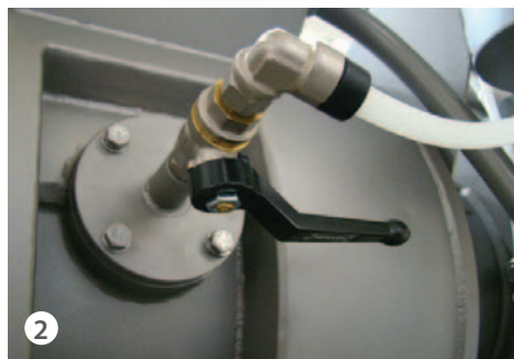
2 Mischkammer komplett mit Doppelmantel auf dem zylindrischen Teil des Mixers (optional)
