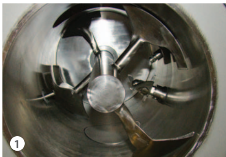
1 Mischkammerinnenseite mit verschweißten Pflugscharen und polierter Oberfläche
