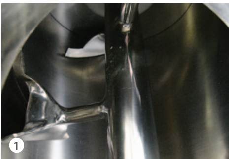
Mischkammerinnenseite mit verschweißten Pflugscharen und polierter Oberfläche
