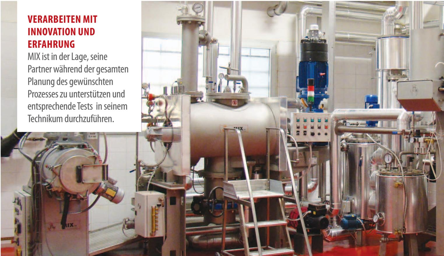
MIX glaubt fest an Forschung, Entwicklung und Innovation und hat deshalb sein Technikum in jüngster Zeit durch neue Maschinen und die Erweiterung des Spektrums der ausführbaren Prozesse erweitert. Es ist möglich, vollautomatisch chemische Reaktionen, physikalische Schwankungen, Feuchtigkeitsgehalt in Produkten, Temperatur- und Drucksteigerungen zu steuern.
